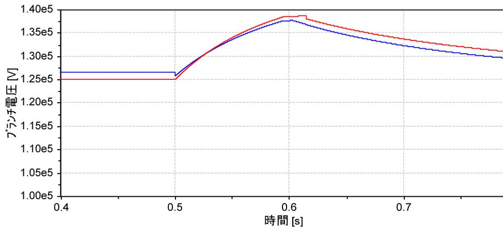
図2 直流電圧 [p.u.] 青線：端子1，赤線：端子2（基準電圧は125 kV）
