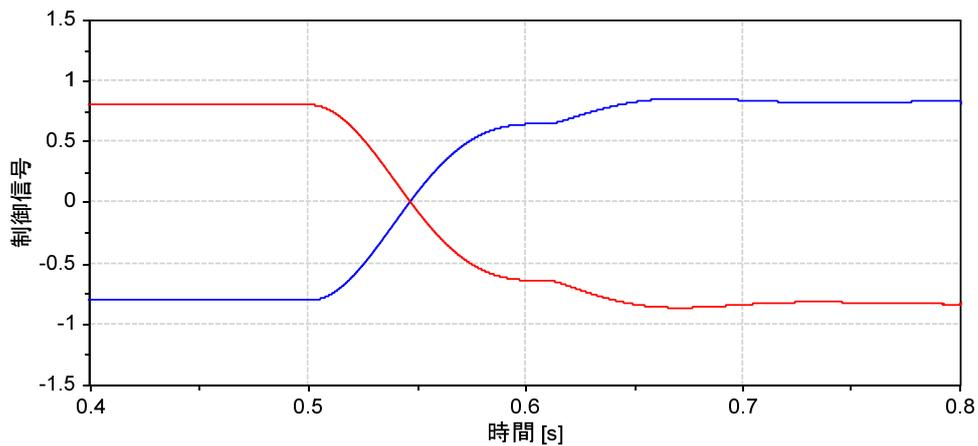
図4 有効電力 [p.u.] 青線：端子1，赤線：端子2（基準容量は55.9 MVA）
