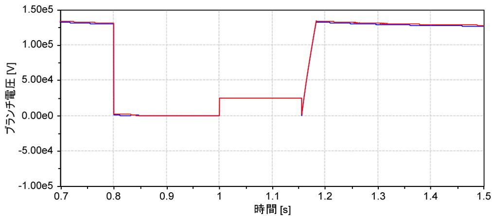
図6 直流電圧 [V] 青線：端子 1，赤線：端子 2（基準電圧は 125 kV）
